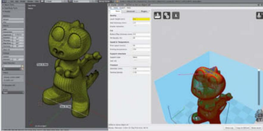
3D-Druck-Werkzeugkasten: Die 3D Print Toolbox bietet Statistiken, Tests auf Fehler, Werkzeuge zum Bereinigen des Meshes, auf 3D-Druck zugeschnittene Skalierungsoptionen und kümmert sich auch gleich noch um den Export des Objekts.
